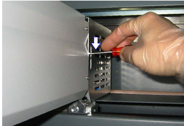
Abb. 8-3 Schlitz zum Lösen der Bremse
