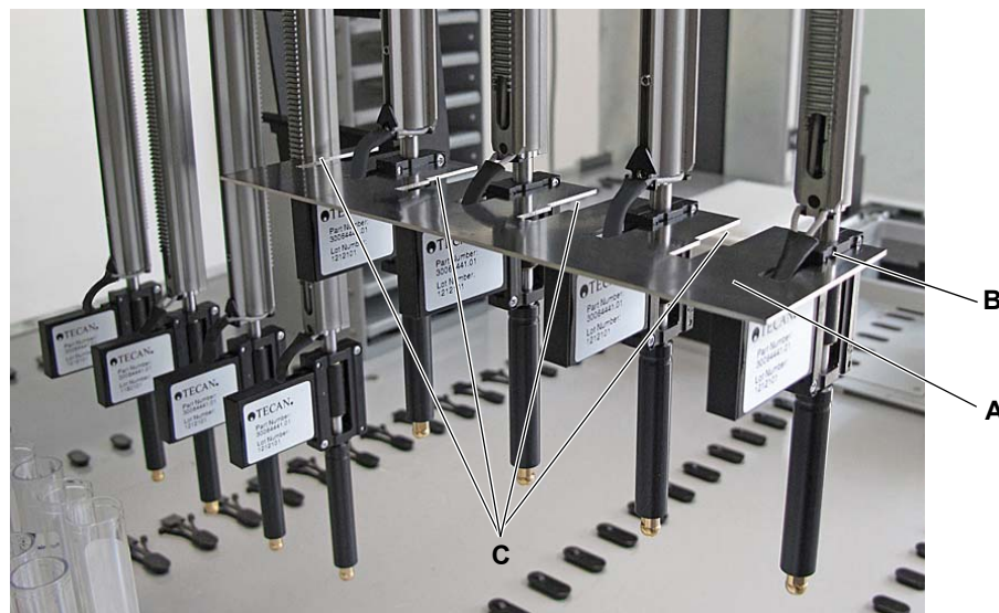
Abb. 7-9 Einsetzen der Einstelllehre für Air LiHa-Spitzenadapter
