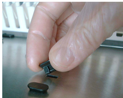
Abb. 7-51 Einsetzen eines Positionierzapfens
