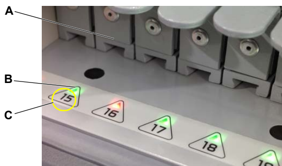
Fig. 6-3 Indicadores LED de la interfaz de carga
