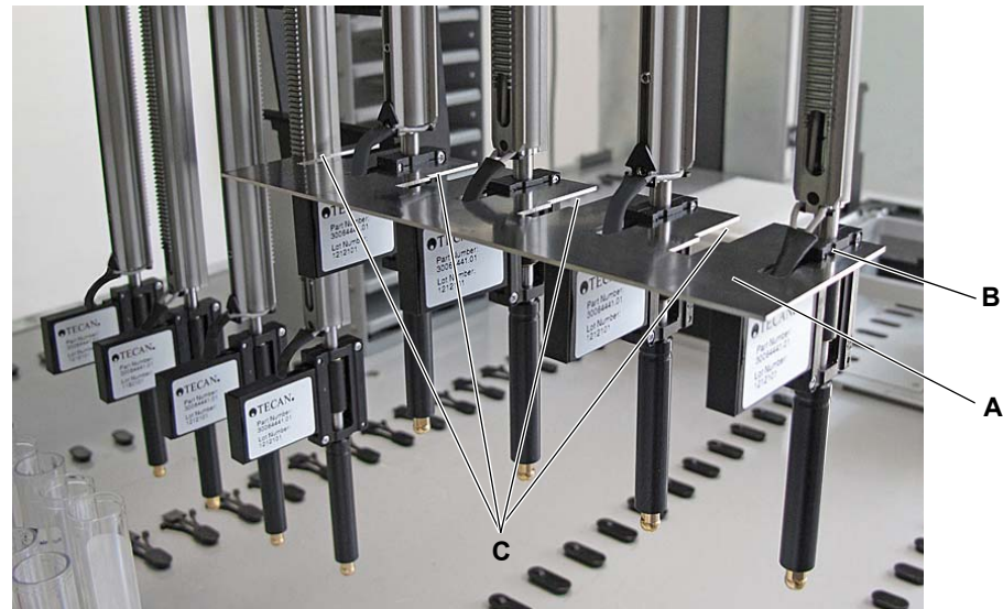
Fig. 7-9 Inserción del indicador de ajuste para adaptadores de puntas del Air LiHa
