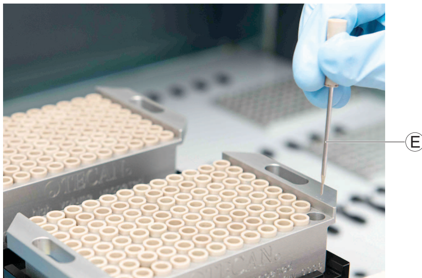
Fig. 7-39 Extracción de la aguja de acero
