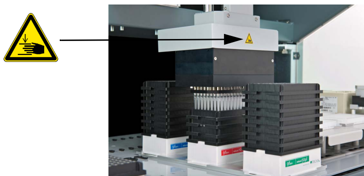
Fig. 2-7 Avisos de seguridad en la cubierta del cabezal de pipeteo del MCA96
