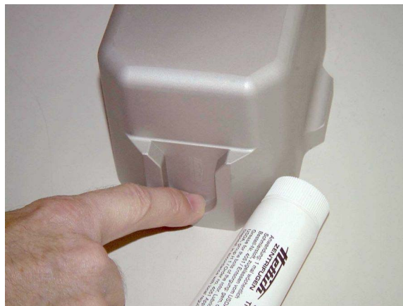
Fig. 7-48 Engrase de la superficie de los cojinetes
