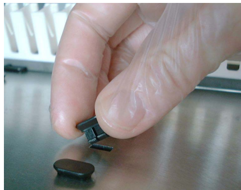
Fig. 7-51 Introducción de un pin de posicionamiento
