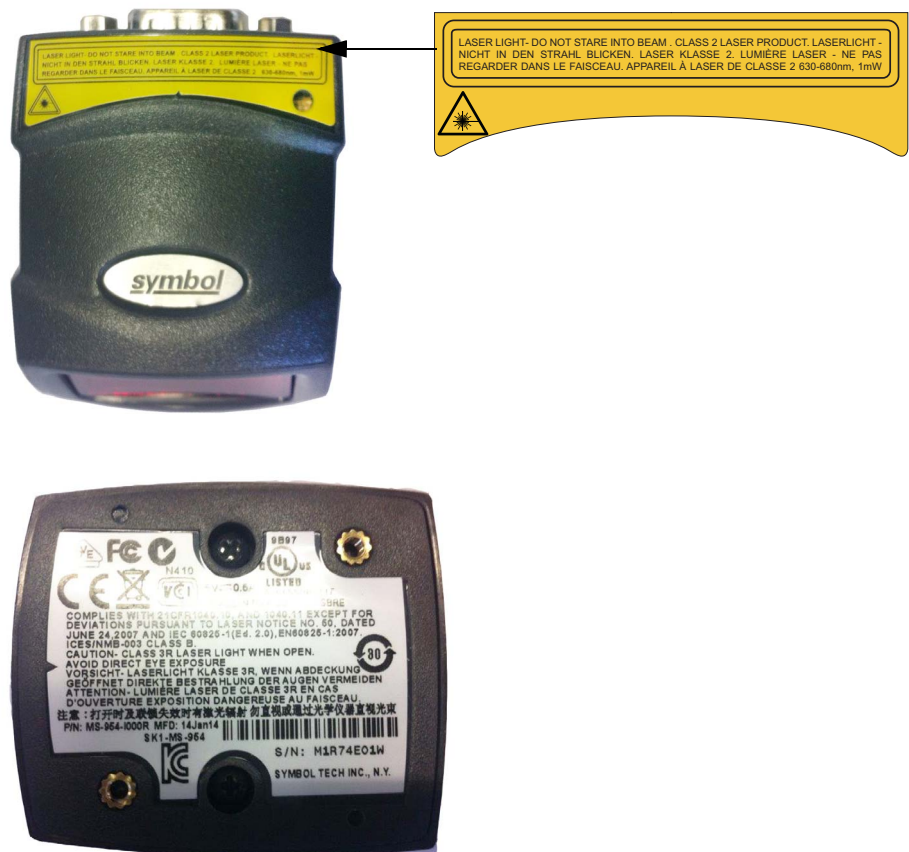
Fig. 2-14 Etiqueta de advertencia sobre láser en el lector de códigos de barras Symbol
