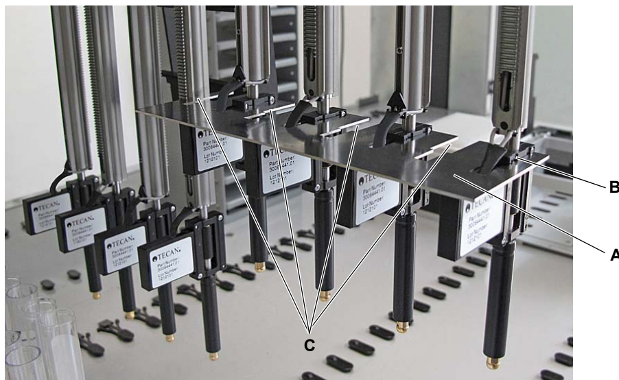
Afb. 7-9 Inbrengen van de afstelmeter voor Air LiHa-tip-adapters
