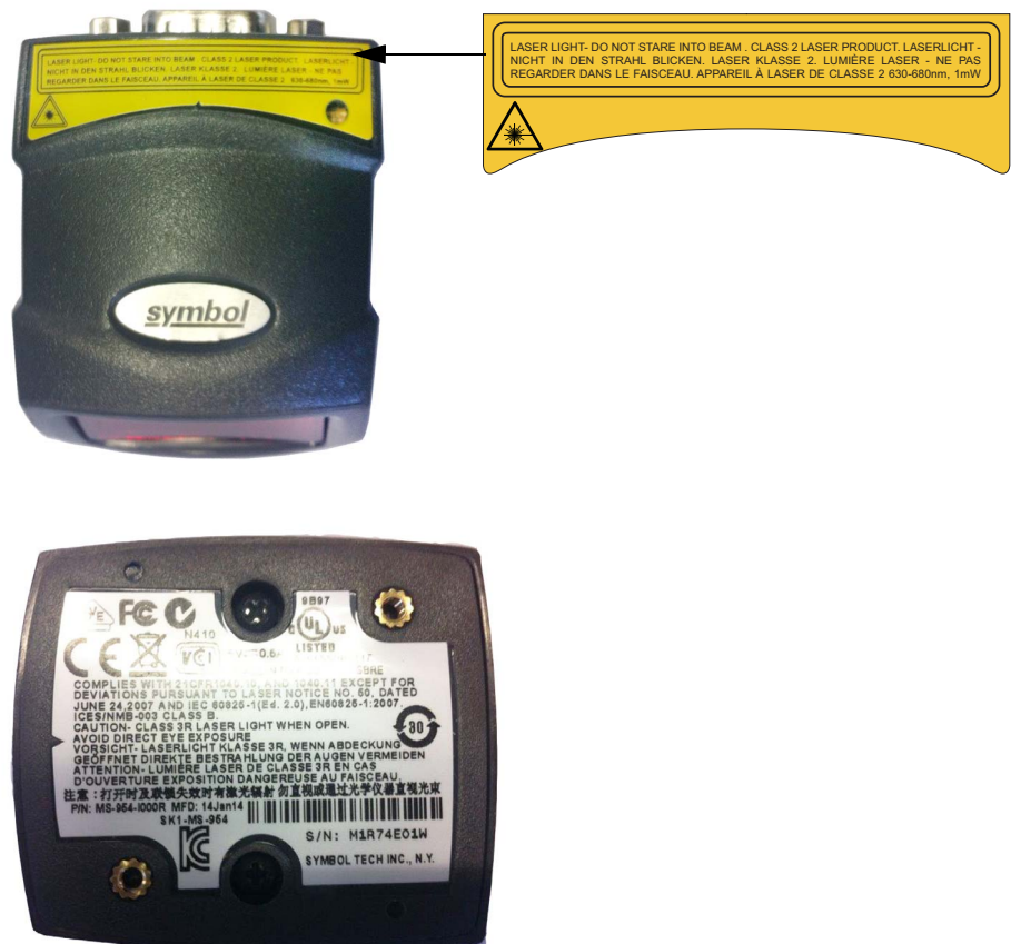
Рис. 2-14 Обозначение лазерного излучения на сканере Symbol BC
