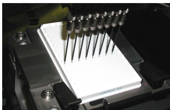
Рис. 4-6 Наконечники Te-PS для микропланшета на 1536 лунок
