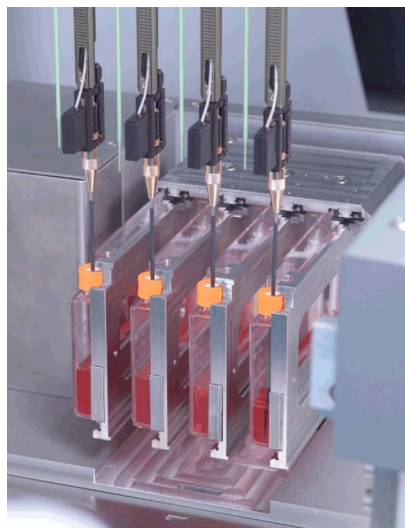
Рис. 4-92 Флиппер для культуральных матрасов в вертикальном положении для прокола мембраны и пипетирования
