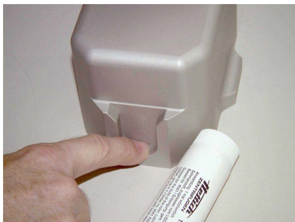
Рис. 7-48 Смазка опорной поверхности
