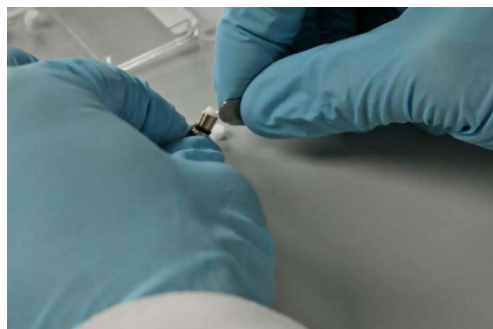
Рис. 7-14 Извлечение проходного фильтра
