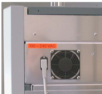
Рис. 9-2 Шнур питания/гнездо сетевого питания
