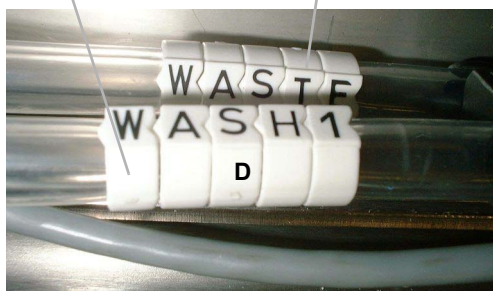
Рис. 5-7 Соединения промывочного блока
