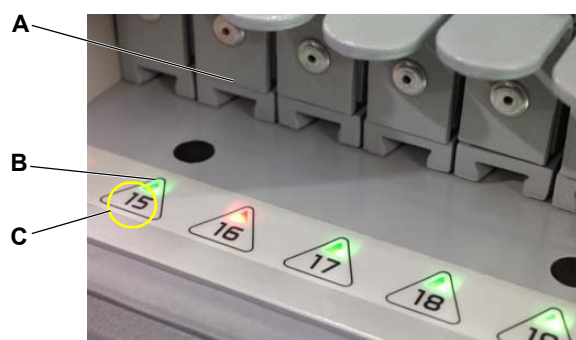
Рис. 6-3 Светодиодный индикатор загрузочного интерфейса
