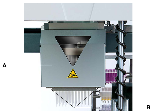
Рис. 2-5 Защитные крышки 384-канальной пипетирующей головки
