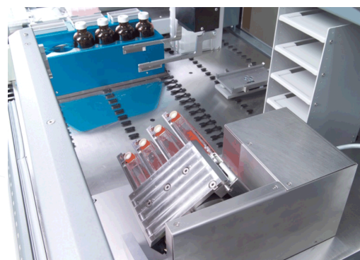
Рис. 4-91 Флиппер для культуральных матрасов в горизонтальном положении и при встряхивании
