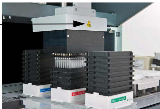
Рис. 2-7 Предупреждающие обозначения на крышке пипетирующей головки МСА96
