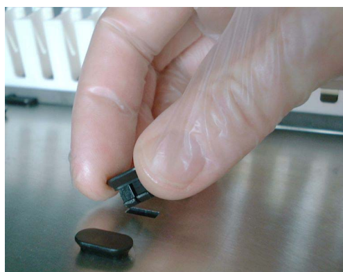
Рис. 7-51 Установка направляющего штифта
