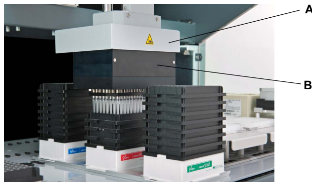
Рис. 2-4 Элементы безопасности/крышки 96-канальной пипетирующей головки
