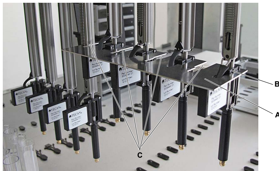
Рис. 7-9 Вставка калибровочной пластины для адаптеров наконечников пневматического устройства LiHa
