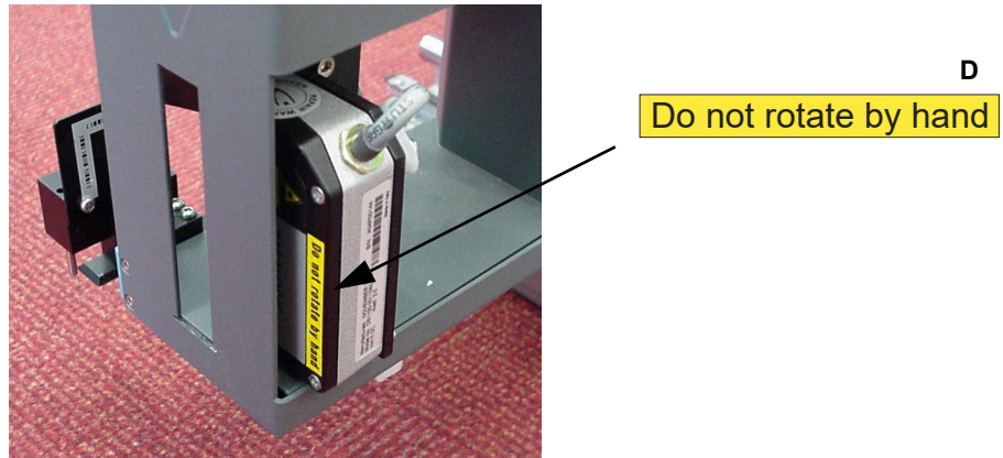
Рис. 2-12 Обозначение на головке сканера PosID
