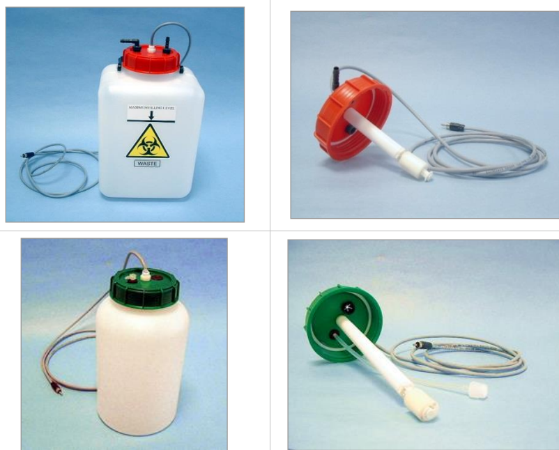
图 2.1 带有 LLD 传感器的废液瓶和洗液瓶
