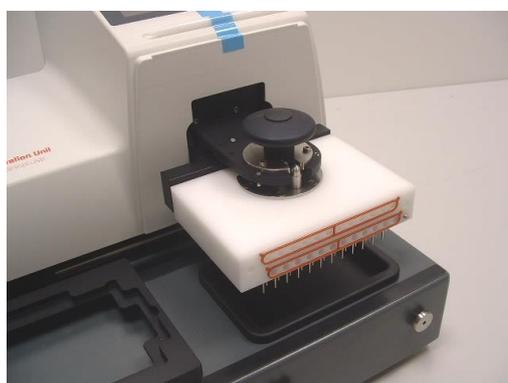
3. Inumidire le guarnizioni installate sulla testa di lavaggio con acqua distillata/deionizzata.
