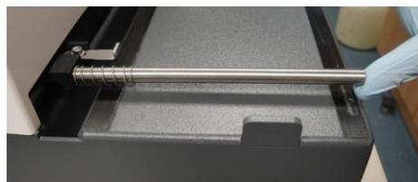
Posizionare il portapiastre sulla barra di guida. Sollevare il lato destro del portapiastre per farlo scorrere sull'elemento di posizionamento.
