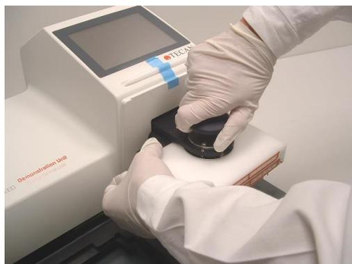
6. Serrare accuratamente la manopola sulla parte superiore della testa di lavaggio tenendo la testa di lavaggio e la barra nera in posizione. Ricontrollare l'allineamento della testa di lavaggio e della barra nera (la guarnizione non dovrebbe essere visibile).
