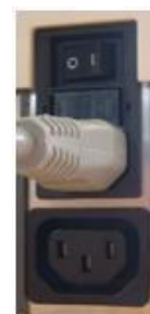
Enchufe de suministro eléctrico
