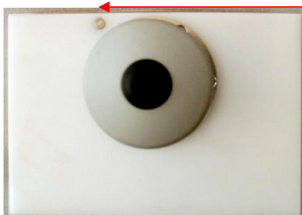
El cabezal de lavado 384HT tiene un imán a la izquierda
