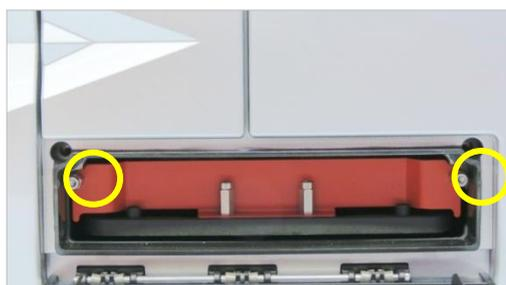
4. Retirer les vis du verrouillage de transport.
