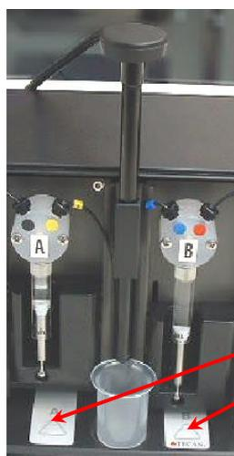
Boutons d'amorçage/de lavage pour les injecteurs A et B
