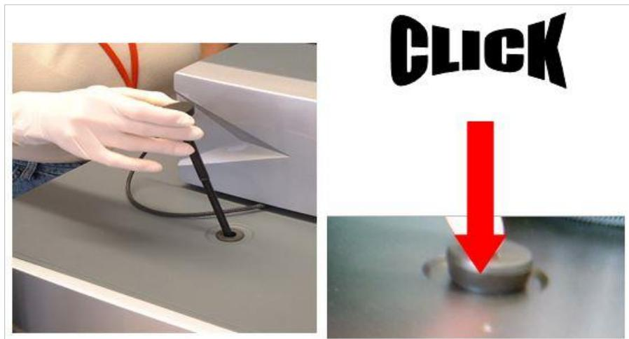
Figure 7 : Insertion du porte-injecteur dans le port de l'injecteur
