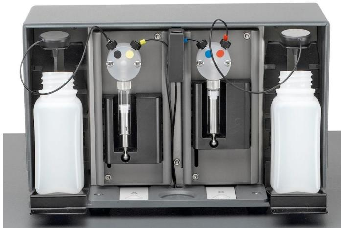
Obrázek 3: Jednotka injektoru s držáky láhví
