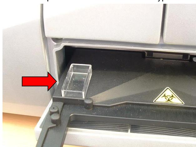
Obrázek 30: Odpadní nádobka na držáku destičky
