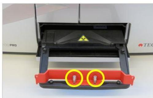
5. Снимите транспортный фиксатор с каретки планшета.
