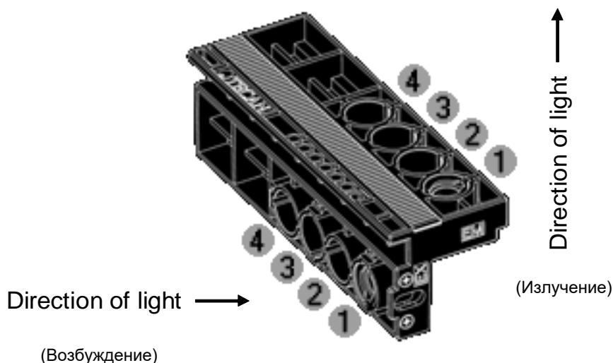
Рис. 24. Конфигурации Infinite F: Кассета фильтров - направление света
