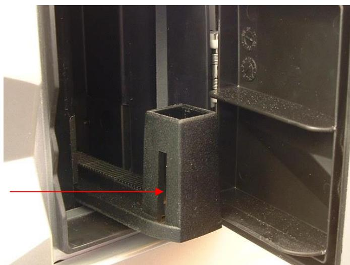
Рис. 21. Порт кюветы в конфигурациях Infinite M
