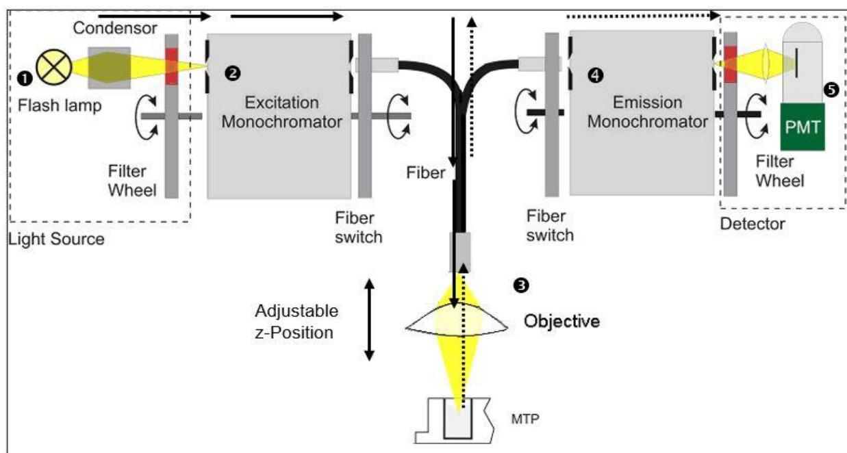
Рис. 8. Оптическая система измерения интенсивности флуоресценции с чтением сверху
