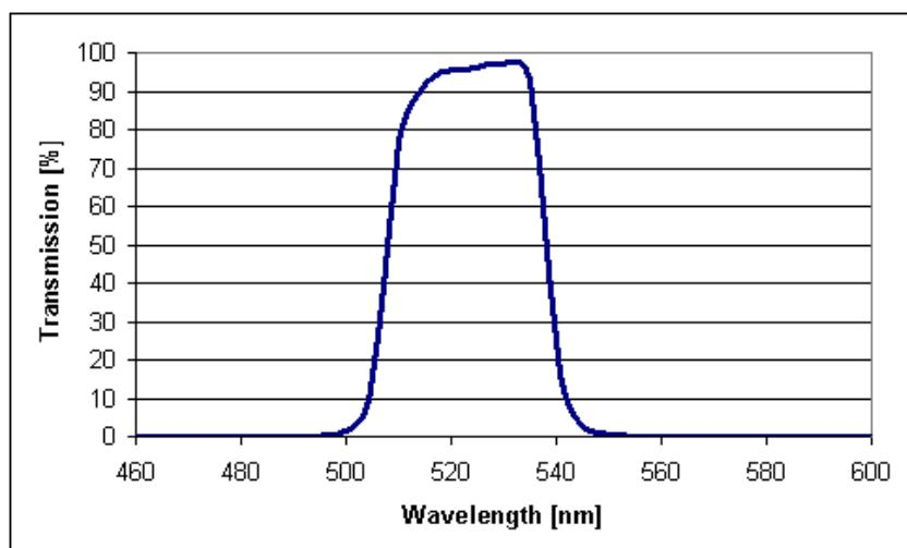
Рис. 17. Спектр пропускания фильтра *Люми. зел.*
