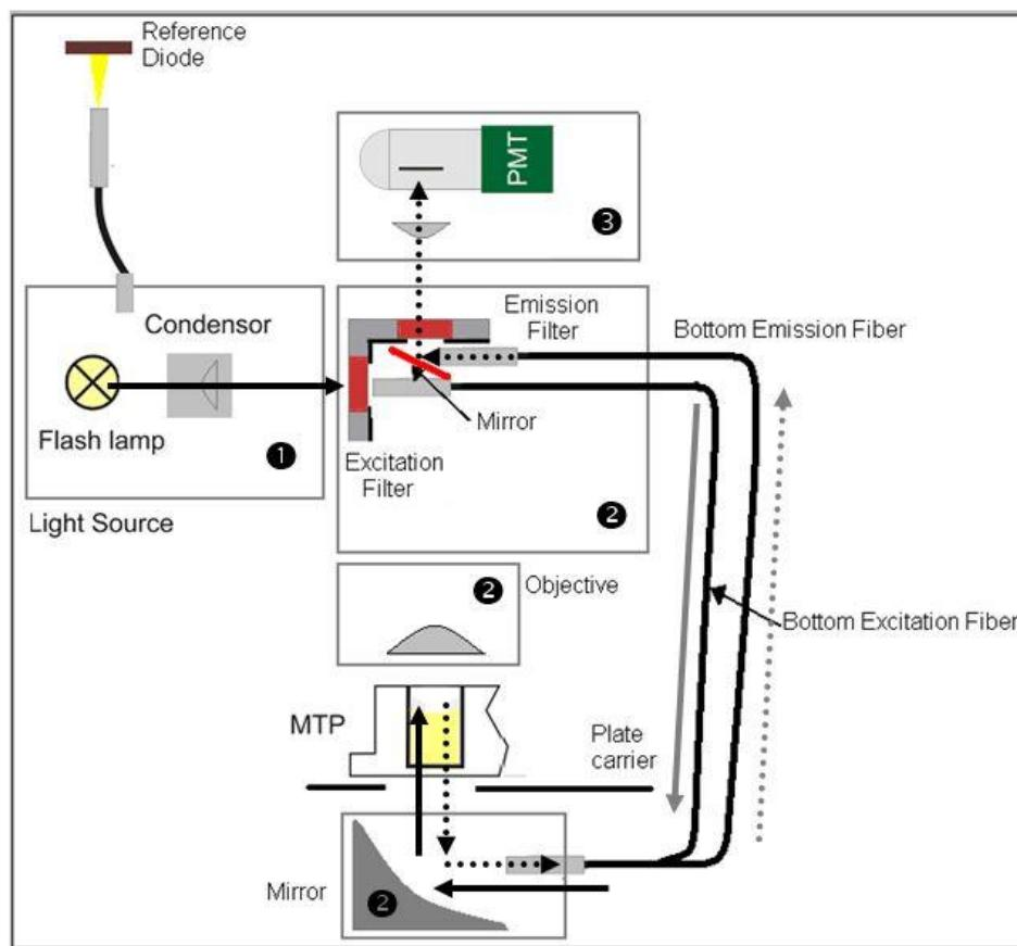
Рис. 12. Система измерения интенсивности флуоресценции с чтением снизу конфигураций Infinite F
