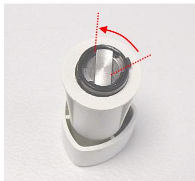
Инструмент для монтажа фильтров со стопорным кольцом
