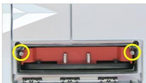
4. Выверните винты из транспортного фиксатора.
