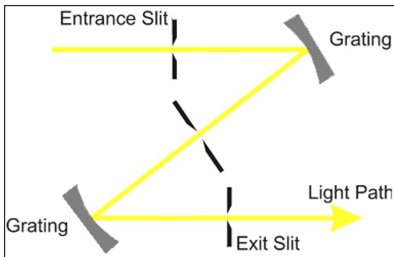
*Рис. 10. Детальный вид двойного монохроматора возбуждения и излучения*
