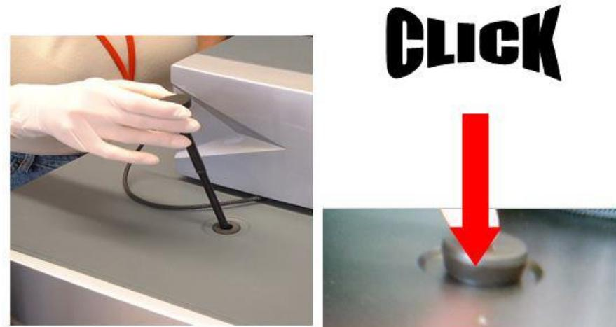
Рис. 7. Установка штатива инжектора в порт инжектора
