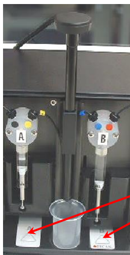
Figura 29: Scatola iniettori con iniettori in posizione di manutenzione ; gli iniettori vengono rimossi dall'alloggiamento del porta-iniettori e inseriti nel supporto del sistema porta-iniettori.
