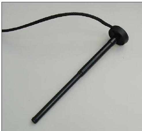
Figura 6: Portador del inyector
