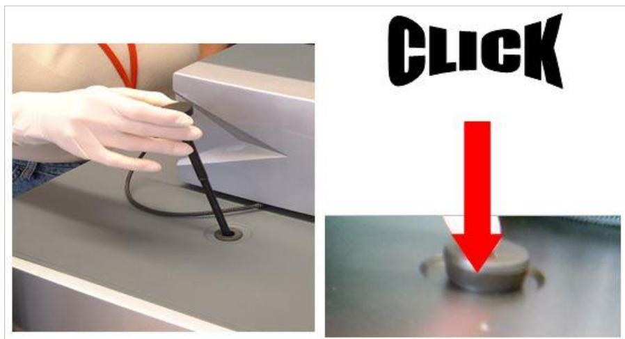
Figura 7: Introducción del portador del inyector en el puerto del inyector
