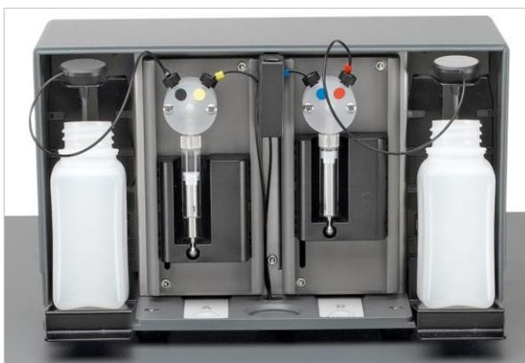
Figura 3: Caja de inyector con portabotellas
