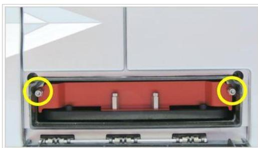
4. Retire los tornillos del inmovilizador de transporte.
