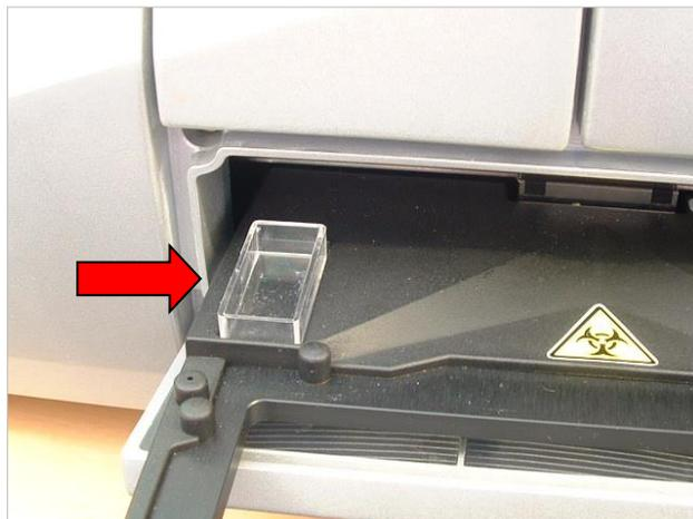
Figura 30: Cuba de descarga en portaplasmas
