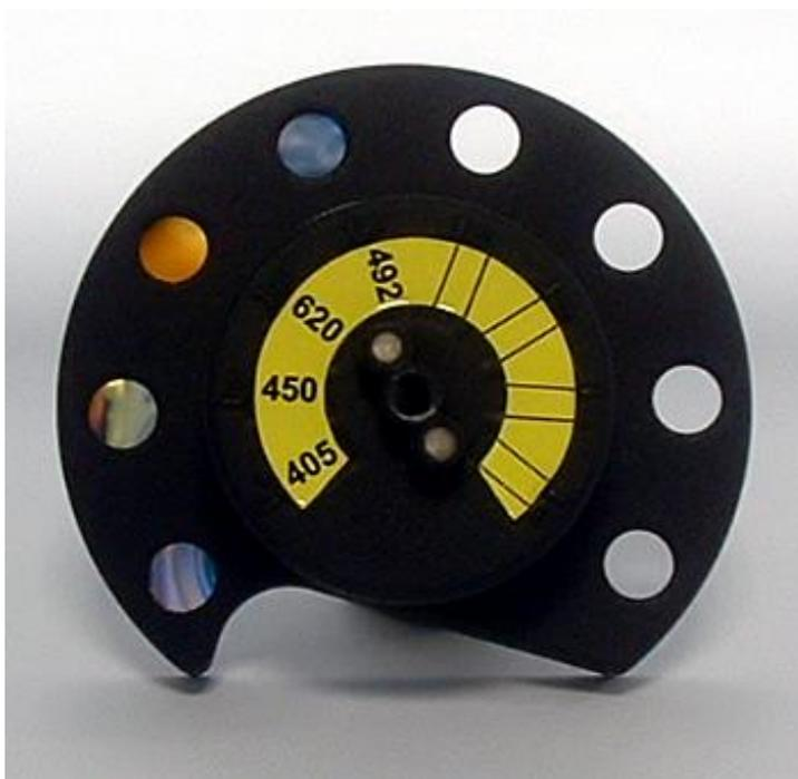
Quando si seleziona una lunghezza d'onda per la misurazione, il filtro specifico viene condotto nel fascio di luce spostando la ruota portafiltri nella giusta posizione.
