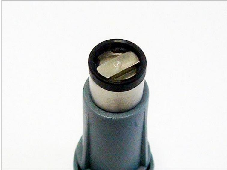
15. Con la herramienta de montaje de filtro, empuje el anillo de retención dentro de la ranura de filtro y ajústelo firmemente en su lugar.
