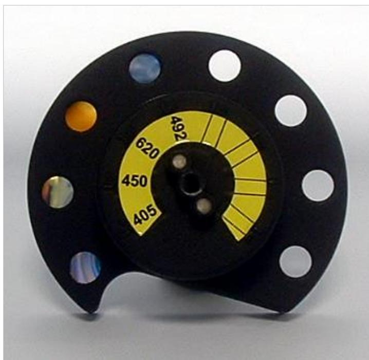
Cuando se selecciona una longitud de onda para una medición, la rueda de filtros se mueve a la posición correspondiente para llevar el filtro específico hasta el rayo de luz.
