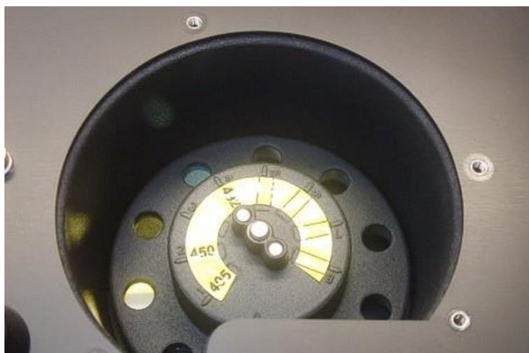
9. Coloque la rueda de filtros en una superficie plana y limpia.
