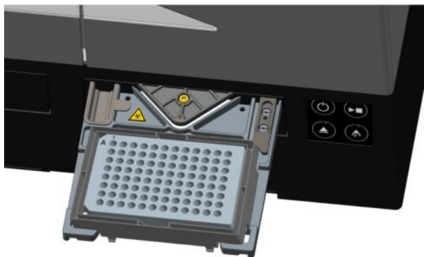
Figure 30 : Microplaque sur le porte-plaque avec le puits A1 dans le coin supérieur gauche
