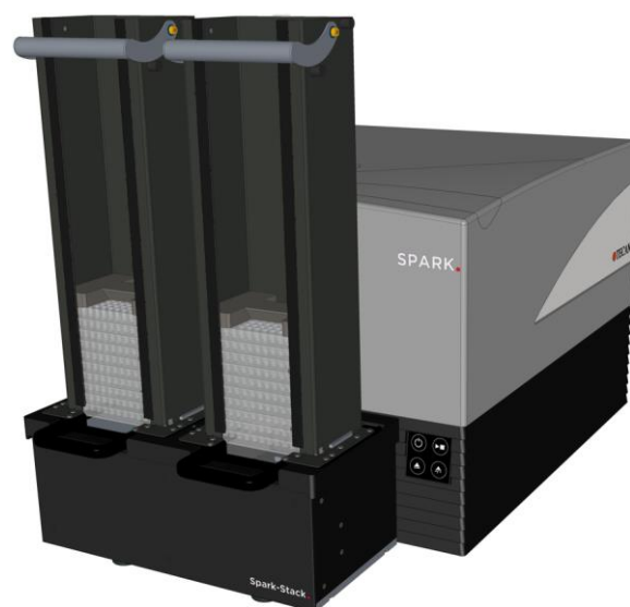
Figura 17. Impilatore per micropiastre incorporato Spark-Stack, per caricare, scaricare e rimpilare automaticamente fino a 50 piastre per ciascun ciclo di misurazione.
