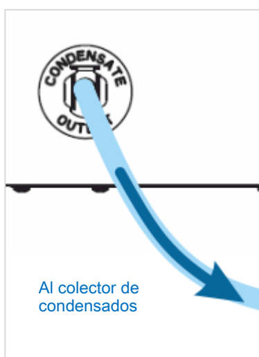
Figura 22: Salida de condensados
