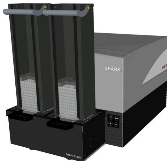
Obrázek 17: Vestavěný stohovací modul Spark-Stack k automatickému vkládání, odebírání a opětovnému stohování až 50 destiček na jeden chod.
