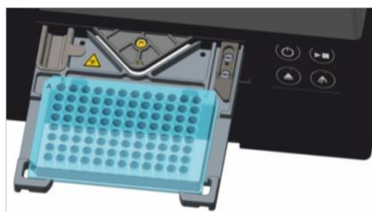
Abbildung 2: Mikroplatte auf dem Plattenträger mit Well A1 in der oberen linken Ecke.
