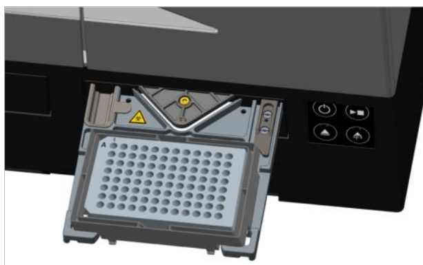
Abbildung 31: Mikroplatte auf dem Plattenträger mit Well A1 in der oberen linken Ecke.
