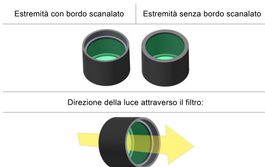
Figura 8: La luce viaggia dall'estremità con bordo liscio all'estremità con bordo scanalato.
