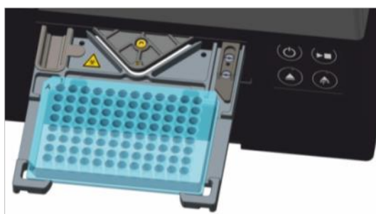
Figura 2: Micropiastra sul porta-piastre con il pozzetto A1 nell'angolo superiore sinistro
