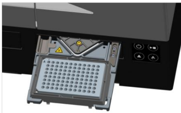
Figura 31: Micropiastra sul porta-piastre con il pozzetto A1 nell'angolo superiore sinistro
