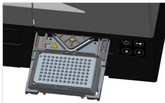
Рис. 31. Планшет на каретке планшета с лункой A1, расположенной слева вверху
