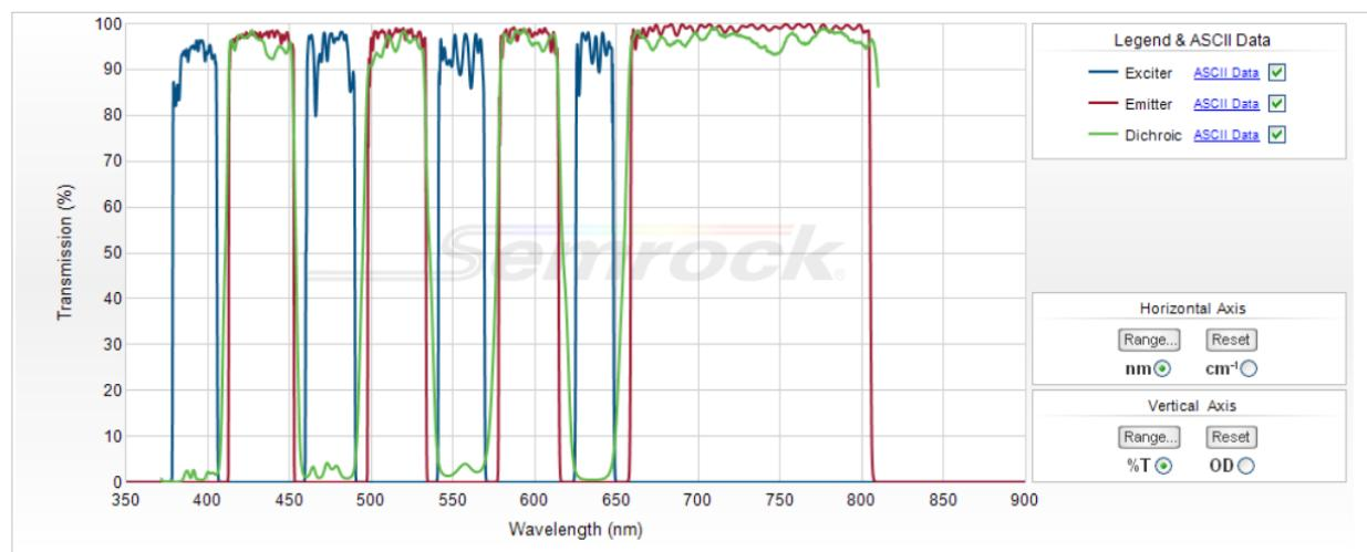
Рис. 16. Профиль пропускания полного многополосного набора фильтров для встроенного Т-изображения (с официального веб-сайта Semrock: [www.semrock.com](http://www.semrock.com))
