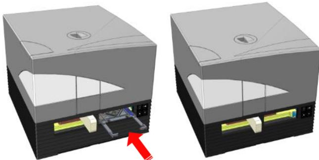
7. Поверните оставшийся кусок пенополиэтилена на 90° против часовой стрелки и извлеките его из прибора (см. рис. ниже).
