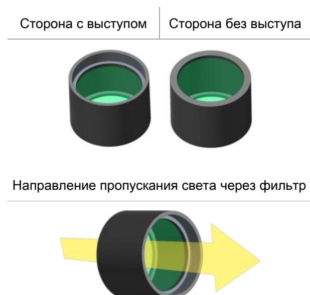
Рис. 8. Свет должен проходить от стороны без выступа к стороне с выступом.
