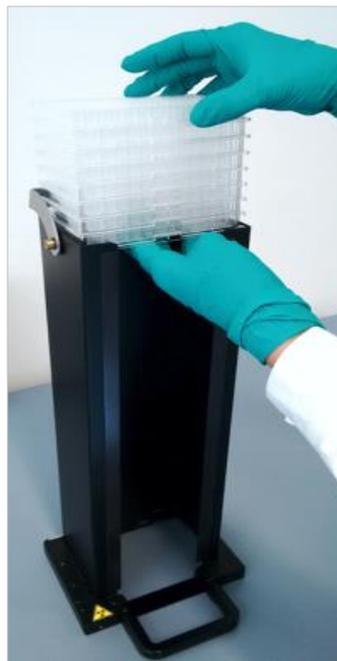
3. 小心地将一只手放在微孔板塔底部的微孔板下方，另一只手扶稳要卸载的一组微孔板。
