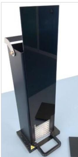
1. 将前遮光罩放到微孔板塔的磁条上。
