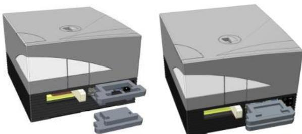
6. 用手推压载板架上的泡沫块，尽量将载板架推入到右侧隔室中。
