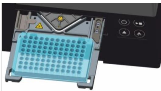
图 2: 微孔板在载板架上，其中 A1 孔在左上角
