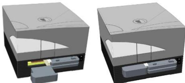
8. 用胶带封住关闭的滤波片室门（见下图）。
