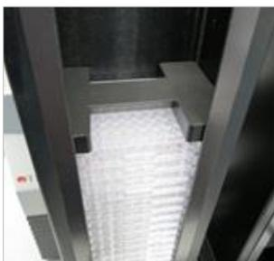
2. 将稳定器配重放在输出塔的底部。
