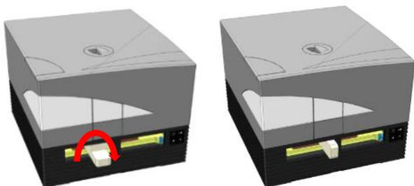
4. 小心地用手将载板架向外移，直到从后面轻轻压向插入的白色泡沫块，并且不能进一步向外移动。
