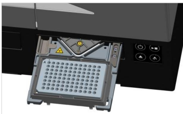
图 31: 微孔板在载板架上，其中 A1 孔在左上角
