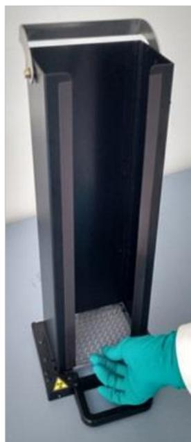
1. 手动将微孔板插入到微孔板塔的顶部，并小心地朝堆栈底部向下放。
